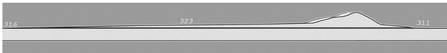
Prerez vzdolž črne črte. Povprečni padec 1.3 promila dopušča rahlo nihanje tudi v vertikalni smeri. Tako lahko potek železnice sledi terenu na konstantni globini oziroma upošteva nekatere druge pogoje pri urejanju naselja.
